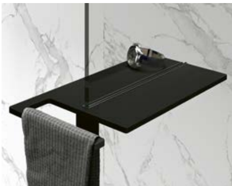
Das HÜPPE Select+ Shower Board mit integriertem Handtuchhalter wird seitlich an das Glas der Seitenwand mit der patentierten HÜPPE Klemmtechnik befestigt. Das HÜPPE Select+ Shower Board ist universell nachrüstbar bei allen Seitenwänden alleinstehend mit 6mm/8mm Glasstärke.
